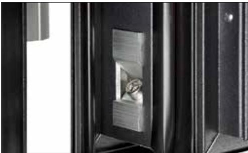
**Stabile Eckverbindungen** Profile auf Gehung verschraubt, verklebt und verbalzt
